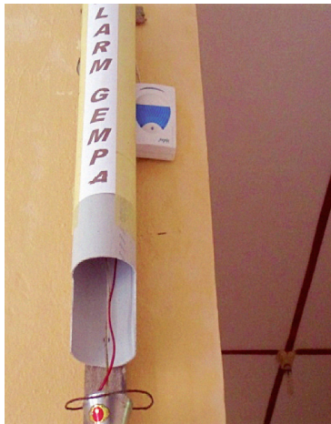
Gambar 5. Alarm Gempabumi, Pada Salah Satu Sekolah Dasar di Pulau Simeulue Terbuat dari Bahan Sederhana.
